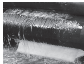
图3 材料 b 通过挤压辊后解吸出甲苯试剂
